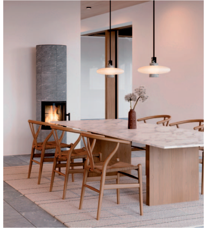
Kraftvolle Wärme des Feuers – und zwar auch noch dann, wenn die Flammen längst erloschen sind. Denn die Wärme wird über lange Zeit im Speckstein gespeichert und als gesunde, angenehme Strahlungswärme sukzessive an den Raum abgegeben. Foto: epr/Tulikivi
