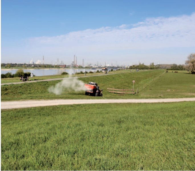
Der kleine Bergtraktor verfügt über Ballonreifen und kann die Deichneigung zur Kalkausgabe gut befahren.
