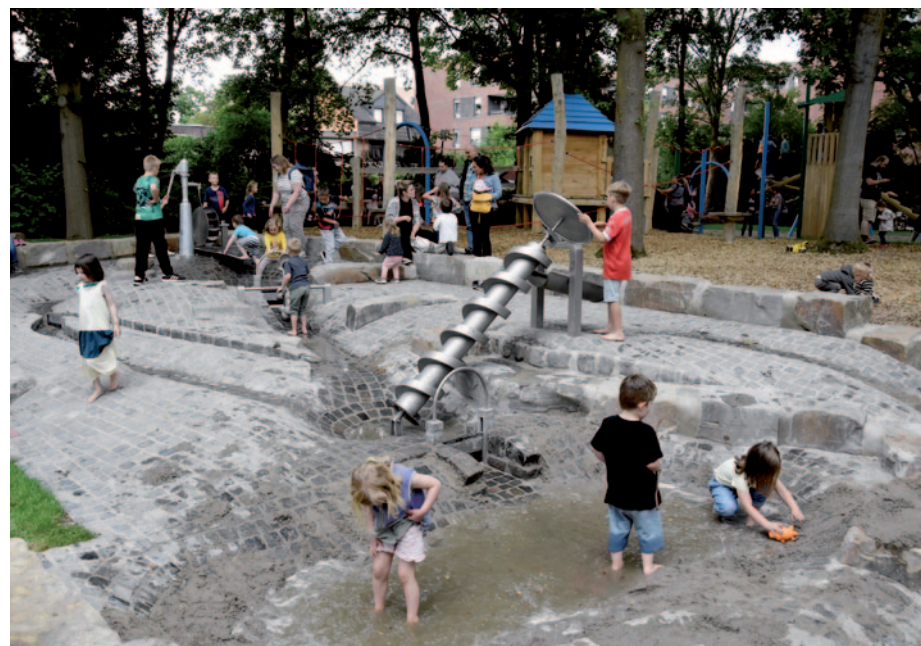
An der neuen Wassermatschanlage fließt Wasser von mehreren Stufen in ein kleines Becken und wird über eine sogenannte archimedische Schraube wieder nach oben befördert.
